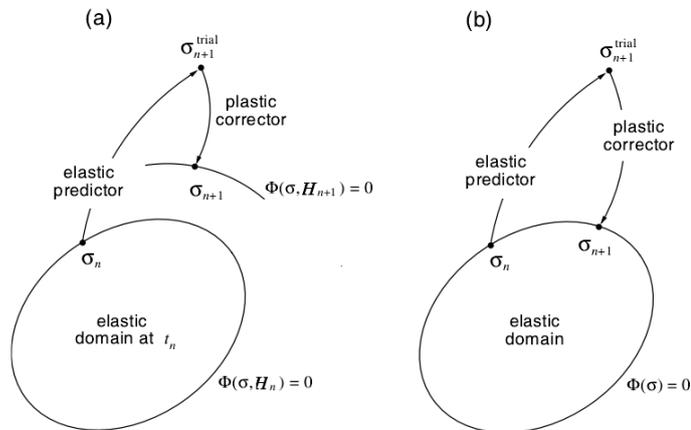
图 9 Return-Mapping 算法示意
