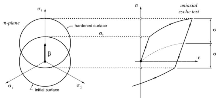
图 8 随动强化模型 (Bauschinger 效应)
