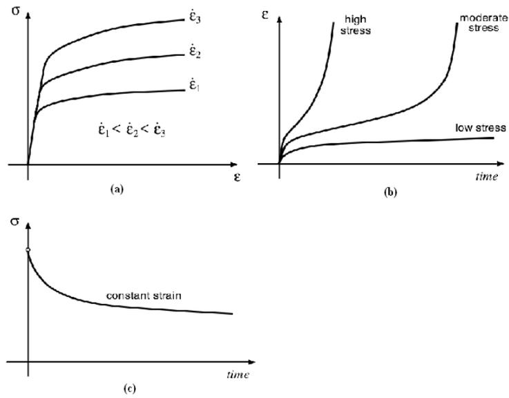
图 6 材料流变性的三种表现形式：(a) 应变率强化；(b) 徐变；(c) 应力松弛
