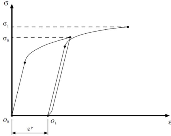
图 5 典型弹塑性应力-应变曲线
