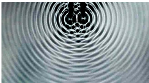
图 9.23 水波的干涉图样
