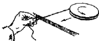
图 6.11 一个力可以使物体同时发生转动和平动
