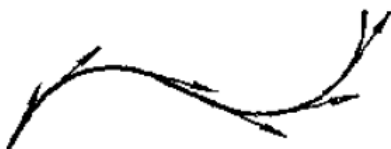
图 4.3 曲线运动中某点的即时速度的方向在曲线的这一点的切线上
