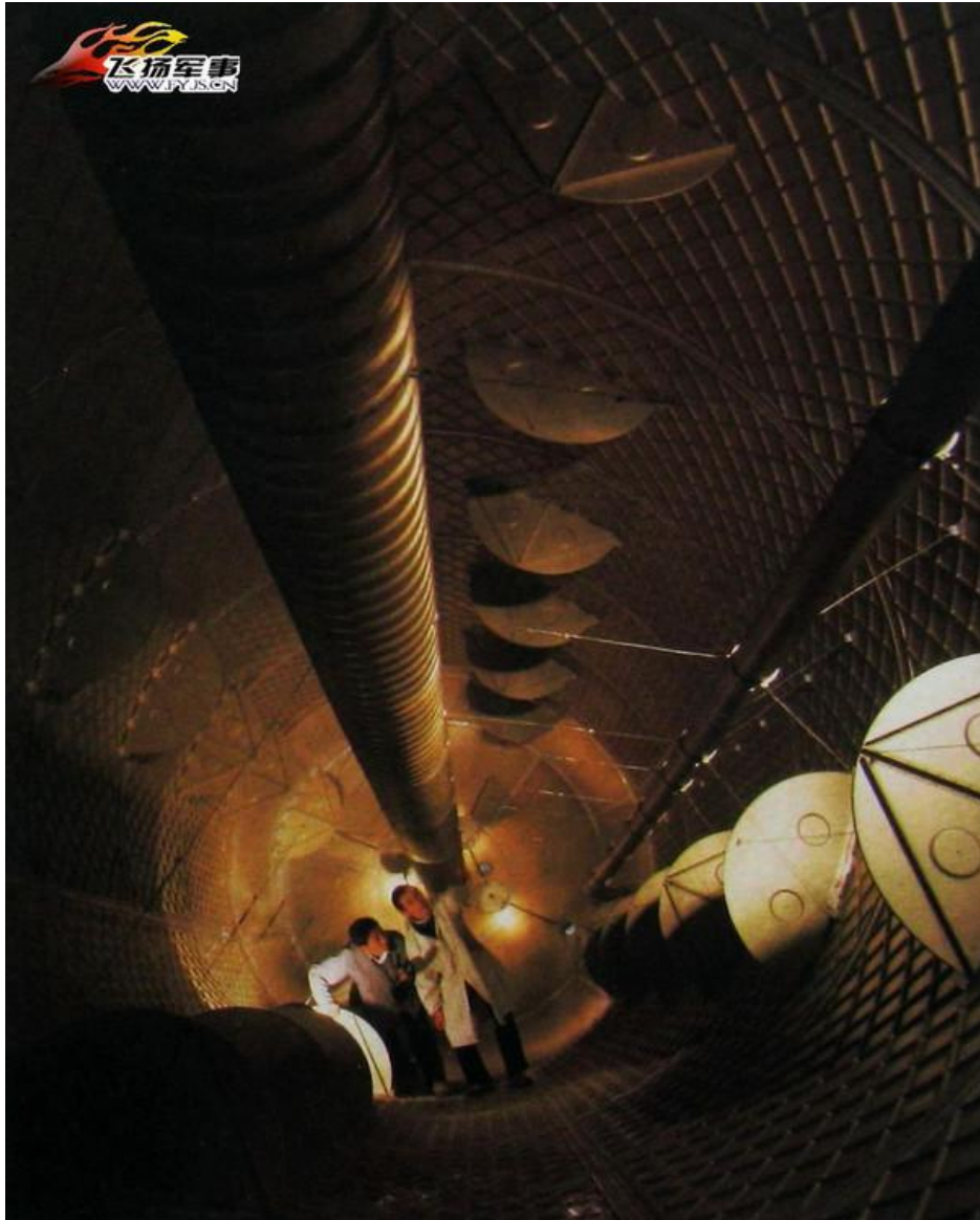
推进剂贮箱，可以看到 网格箱体结构和防晃隔板
