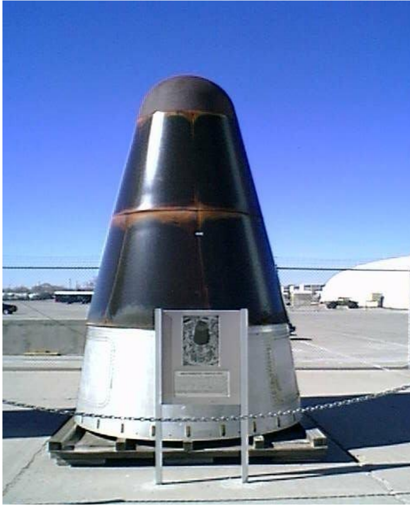
美 国 Titan II 洲际导弹采用的大钝头锥形弹头 Mk6, 重 3.7 吨, 长 3.1 米, 爆炸当量 9 Mt
