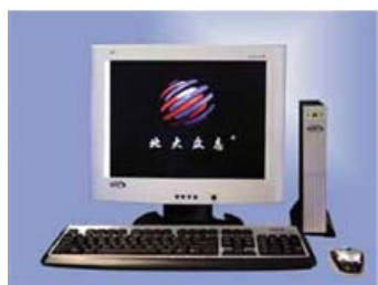
第一代：2003年 分体式计算机产品，基于北大众志 PKUnity-1 系统芯片+显卡的双芯片方案
